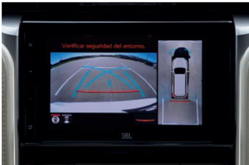
Cámara de estacionamiento con sistema de visión 360°
